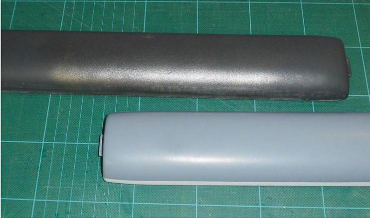
Auch die Wülste werden neu gegossen in Resin.
