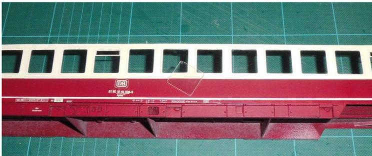
Das Dach wird Quarzgrau gespritzt. (Ral 7039)
